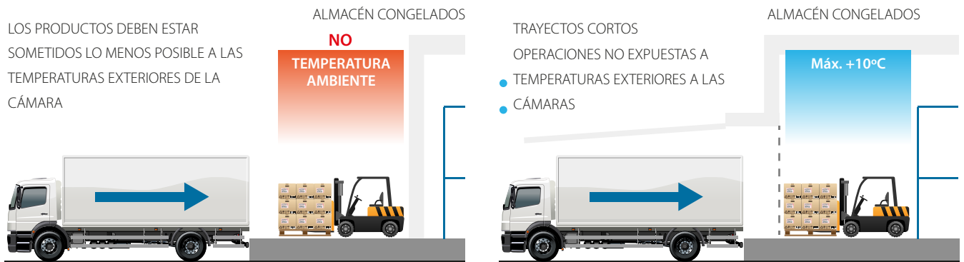
Figura 8. Recomendación en los muelles de carga y descarga
